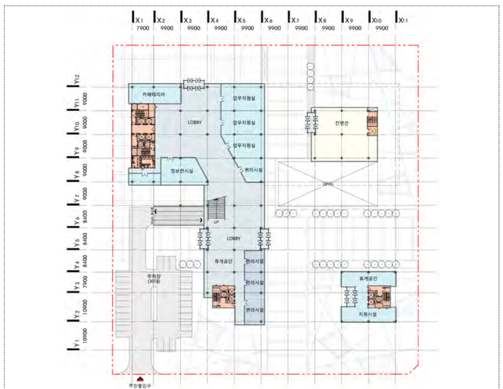
〈 근로자복지타운 및 산학융합센터 1층 평면도 〉
