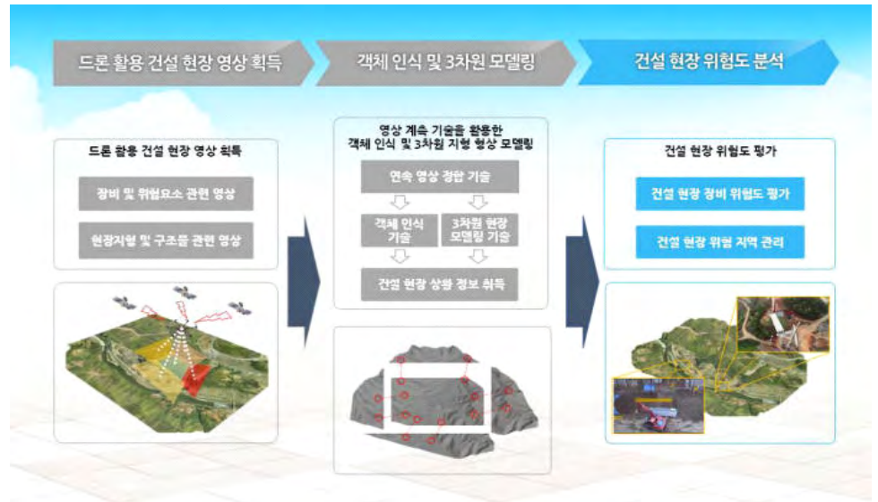
-그림11 드론 및 영상계측 기술을 이용한 안전관리 지원시스템 개념도- (출처: 한국건설기술연구원)
